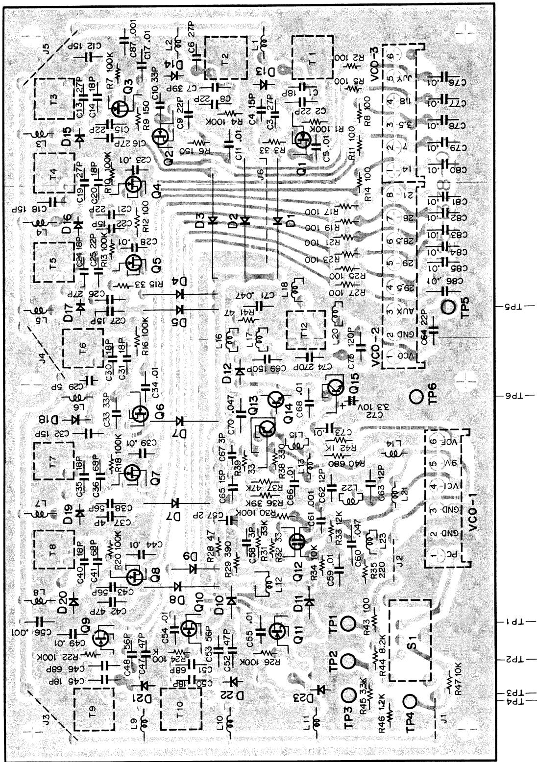
$Q_1 \sim 11$ : 2SK19(BL),  $Q_{12}$ : 3SK41(L),  $Q_{13,15}$ : 2SC460(B),  $Q_{14}$ : 2SC741,  $D_{13} \sim D_{12}$ : 1S2588,  $D_{13} \sim D_{23}$ : 1S1658-2
