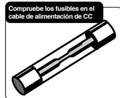
2. Compruebe los fusibles en el cable de alimentación de CC El cable de alimentación principal (rojo) tiene un fusible tipo 3AG de dos amperios en su soporte. Utilice solo el tipo y tamaño de fusible especificado anteriormente para una máxima protección. No hacerlo anulará la garantía.
