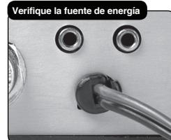
1. Verifique las conexiones a la fuente de energía y asegúrese de que sean los 13,8 VCC necesarios para operar su radio.
