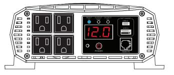
3. Une fois le voyant bleu, l'alarme de basse tension sera définie à 10,5 volts. Le paramètre ne change pas quand le convertisseur est éteint ou que la batterie est débranchée (pour remettre le paramètre par défaut pour l'alarme de basse tension à 11,5 volts, effectuez les étapes 1 et 2).
