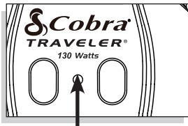
Indicador Encendido / Fault
