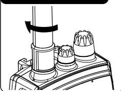
1. Para instalar la antena, gírela dentro del radio a derechas a fin de ajustarla. No ajuste excesivamente
