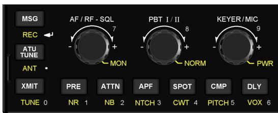
Primero, pulse **FREQ ENT**. A continuación, introduzca los **MHz** tres dígitos, opcionalmente seguido de un punto decimal (tecla **ATU TUNE**) y los **kHz** tres dígitos. A continuación pulse. **<-** (tecla **MSG**) para aceptar, o cualquier otro interruptor para cancelar. **Ejemplos:**
