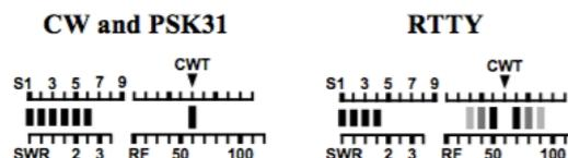
En RTTY o modos *radio-teletipo* (FSK D, A; AFSK, pág. 18) los tonos de marca y espacio están representados por tres barras en cada lado del puntero CWT. Si no hay presencia de señal RTTY, verá el efecto “fantasma” que se muestra arriba. Al sintonizar una señal RTTY, el número de barras sólidas aumentará. Intente la sintonización hasta que vea un equilibrio aproximado entre barras sólidas izquierdas y derechas durante una transmisión RTTY.
