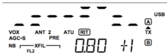
Las frecuencias centrales de las 8 bandas de ecualización de audio son 50, 100, 200, 400, 800, 1600, 2400 y 3200 Hz. Para seleccionar una banda a ecualizar, pulse **1-8** en el teclado. Por ejemplo, la grabación **1** selecciona la banda de 50 Hz.
