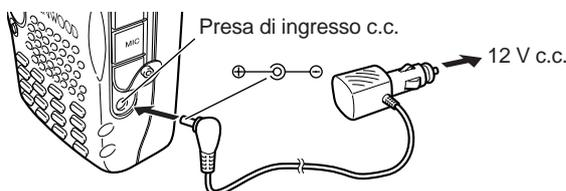
Con il PG-3J collegamento alla presa per accendisigari, il ricetrasmittitore inizia automaticamente la carica del pacco batteria al litio (PB-42L). Quando si utilizza il ricetrasmittitore, la carica della batteria avviene in background. Se il ricetrasmittitore è spento, i 2 LED si illuminano di arancione durante la ricarica. Al termine della ricarica, la spia si spegne (sopra).
