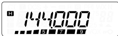
バッテリー残量の目安（ローパワー送信時）
