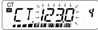
[ENC]ツマミを再度回すと、スキャンを再開します。なお、[ENC]ツマミを反時計方向に回すとCTCSS周波数の低い方向へ、時計方向に回すとCTCSS周波数の高い方向へスキャンします。
