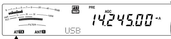
③ 内蔵アンテナチューナーが動作するまで **[AT/ ANT 1/ 2]** を押し続けます。
