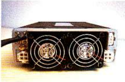
De zender/ontvanger, achterzijde met de dubbele ventilator ten behoeve van de eindtrap.
