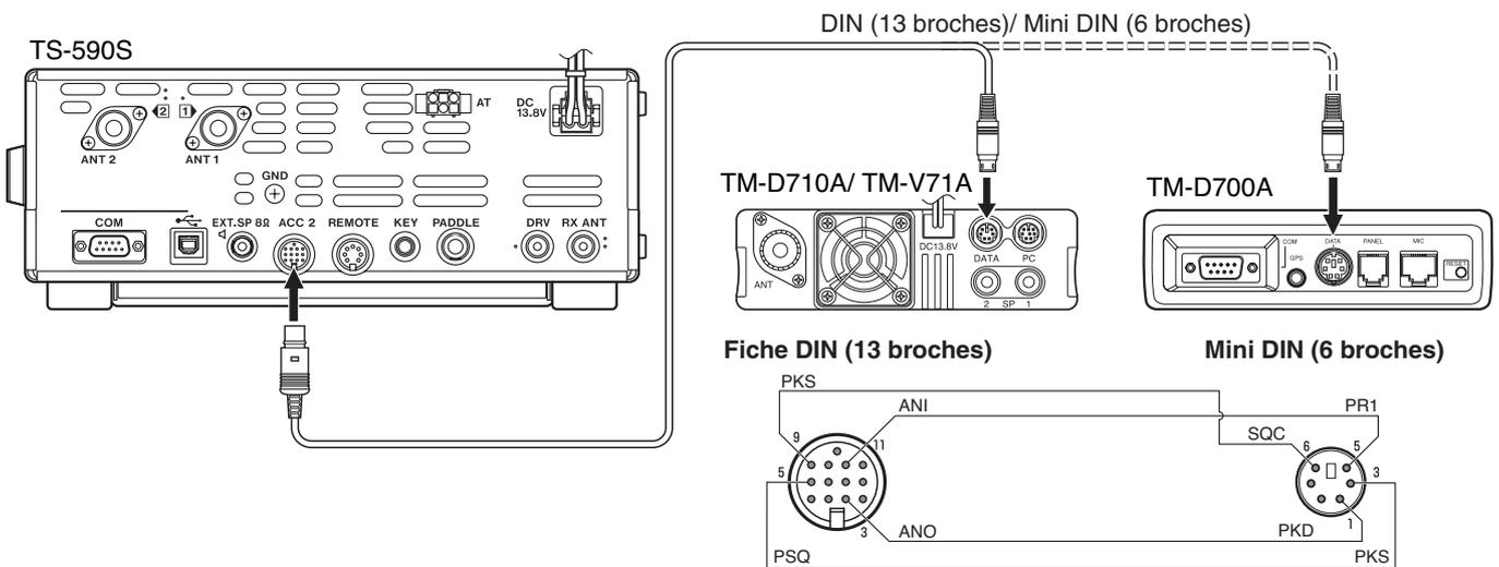
Après avoir connecté les 2 émetteurs-récepteurs au moyen d'un câble, accédez au numéros 73 (polarité PKS) et 74 (Blocage si occupé) du menu sur l'émetteur-récepteur TS-590S pour sélectionner "on". Vous devrez par la suite régler le niveau d'entrée/ sortie audio de l'émetteur-récepteur TS-590S à l'aide des numéros . 66 et 67 de menu.
