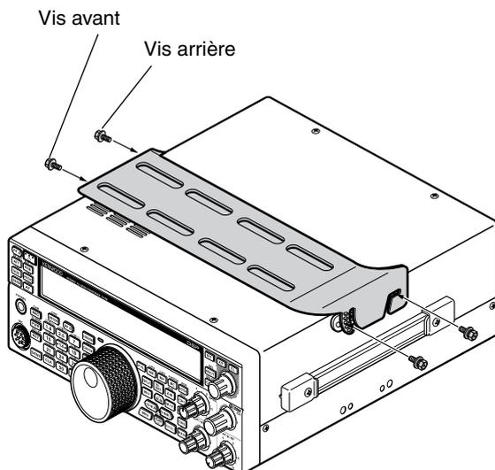
Pour enlever l'émetteur-récepteur de la fixation, enlevez d'abord les vis avant, ensuite, desserrez légèrement les vis arrière et tirez l'émetteur-récepteur vers l'avant pour le déboîter de la fixation.
