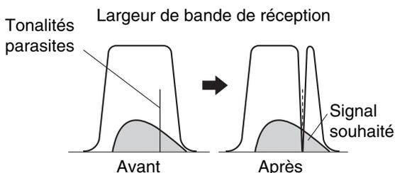
Appuyez et maintenez **[BC (A.NOTCH)]** enfoncée pour basculer entre l'activation et la désactivation du filtre coupe-bande automatique.
