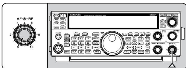
**Remarque :** le réglage de la commande **AF** n'affecte pas le volume de confirmation sonore à l'appui des touches ni le volume d'effet local pour l'émission sur ondes porteuses. Le niveau sonore en mode d'exploitation numérique est aussi indépendant du réglage de la commande **AF**.
