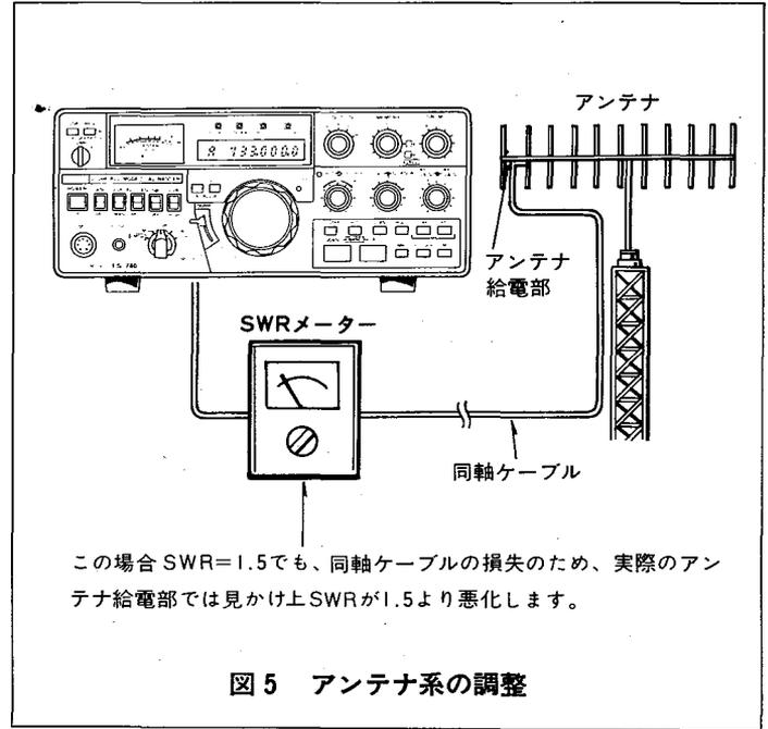
図5 アンテナ系の調整
