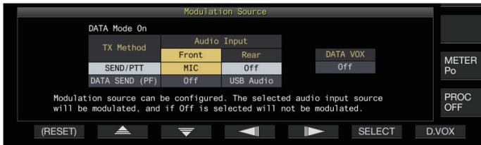
2 F2[▲], F3[▼], F4[◀], F5[▶] を押しして設定したい項目の、「TX Method」(行)で「SEND/PTT」、「DATA SEND(PF)」と「Audio Input」(列)で「Front」、「Rear」を選ぶ
