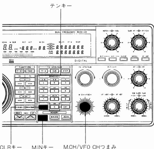
1. M.INキーを押し、メモリースクロール状態にします。なお、表示周波数が変わりますが実際の受信は、M.INキーを押す前の周波数で行われています。
