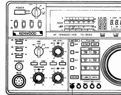
KEY SPEEDつまみを調整して最適のキーイングスピードに合わせます。
