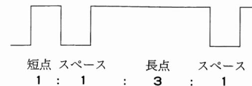
長点と短点の比は、KEY SPEEDつまみの位置に関係なく、1:3の比になっていますが、セット内部のスイッチを切り換えることにより、1:3以外の比に強制的に設定したり(マニュアルウエイト)、キーイングのスピードに連動して自動的に長点と短点の比が変化する(オートウエイト)とすることができます。
