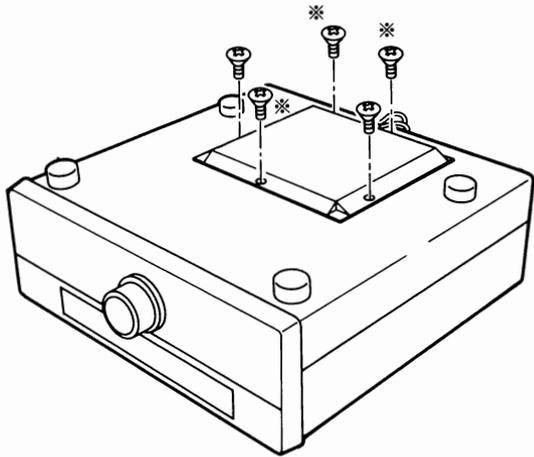
2. DSP-10を取り付け、ねじで固定します。
