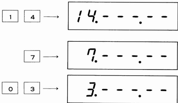
3. テンキーで10Hzの桁まで入力すると、終了します。(ENTキーを押す必要はありません。) また、14.200.00MHzと設定したいときは、1、4、2と押し、ENTキーを押してください。表示は下図のようになります。
