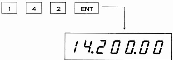
4. 間違えて操作したときは、10Hzの桁の周波数をセットする前か、ENTキーを押す前までに、CLRキーかマイクロホンのPTTスイッチを押すと、もとの周波数に戻ります。
