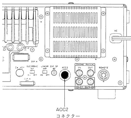
1. 背面パネルのACC2コネクター(13ピン)へ外部から通信用ターミナルの信号ラインを接続します。ACC2コネクターのピン配置図は22ページを参照してください。
