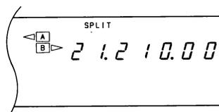
4. M.INキーを押します。メイン周波数表示には、最後に操作したメモリーチャンネルが表示されます。
