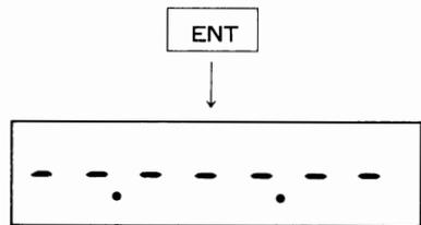
2. 希望する周波数をテンキーにより入力します。10MHzの桁には0~3の数字のみ入力できます。4~9を押したときは、1MHzの桁に入力されます。3MHz以下のときは最初に0を押してください。
