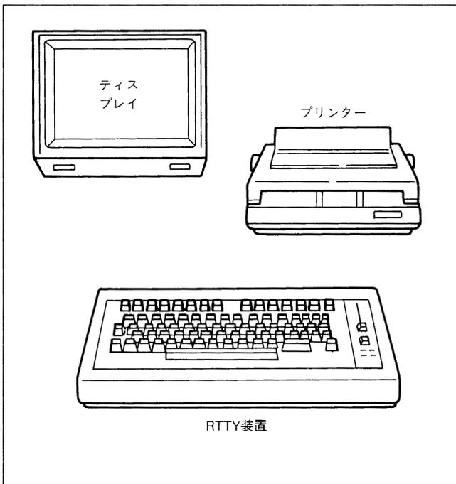
左図のようにキーボードの付いたRTTYターミナルユニットと、モニターディスプレイまたはプリンターで構成されるRTTY装置を使用し、キーボードをたたくと自動的にその文字や数字の符号を送り出し、また受信した符号を自動的に文字や数字に変換してモニターディスプレイに写し出したり、またはプリンターに印字する通信方式をRTTY(ラジオテレタイプ)といいます。
