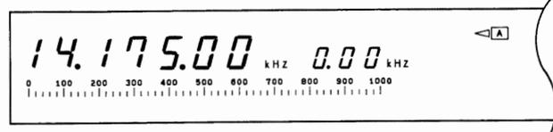
2. M.INキーを押します。メイン周波数表示には、最後に操作したメモリーチャンネルが表示されます。
