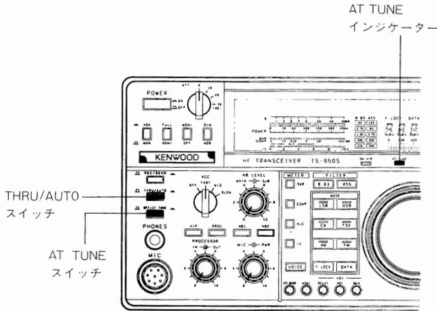
1. THRU/AUTO スイッチを AUTO にします。AT TUNE インジケータが点灯し、プリセットされます。
