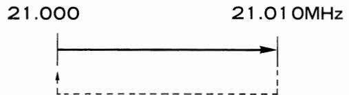
[III] SCANキーを押しながら、テンキーの1および2を押すと、メモリーチャンネル91と92にメモリーした範囲内を繰り返しスキャンします。
