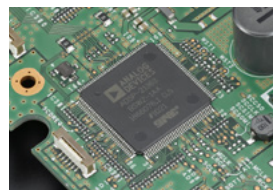
Per modalità banda scope ADSP-21363 clock @333 MHz
