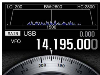
Fréquence de la bande sélectionnée Étendue de la bande audio et cadran
