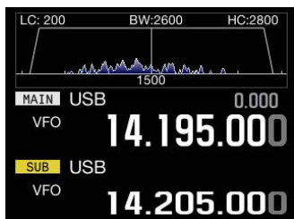
Fréquences de la bande principale et de la sous-bande Étendue audio et étendue de bande
