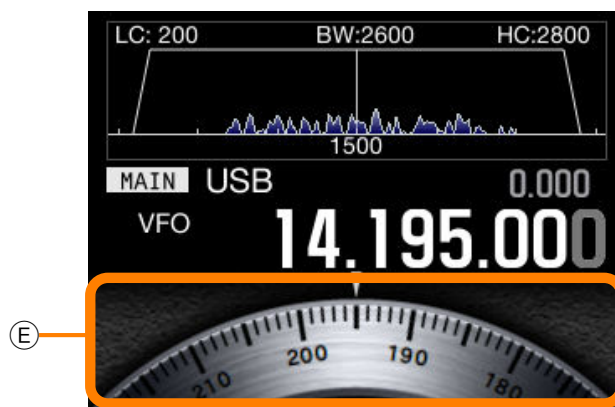
Afficheur de fréquence unique (fréquence/cadran de la bande principale)
