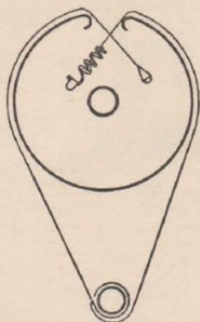
〔第7図〕ダイヤルひものかけ方
