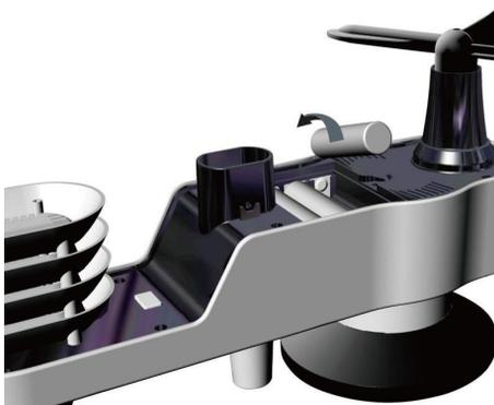
Fermez le couvercle du compartiment à piles. Pour éviter l'entrée d'eau dans le compartiment des piles, assurez-vous que le joint d'étanchéité (autour du compartiment des piles) est bien en place dans sa trace avant de fermer la porte. Serrez la vis de réglage.
