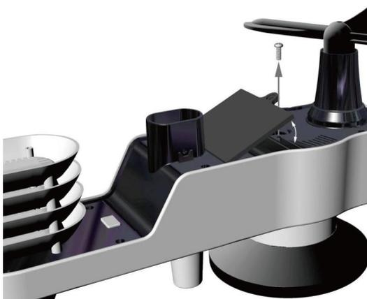
Installez 3 piles AA neuves dans le compartiment à piles. (il est recommandé d'utiliser des piles Li-ion, qui peuvent généralement durer plus d'un an)
