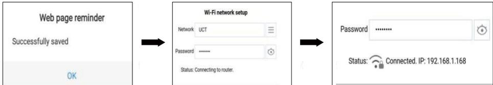
Une fois les paramètres enregistrés, déconnectez à nouveau votre appareil du WLAN de l'unité d'affichage en cliquant sur le bouton [Disconnect], comme indiqué dans la figure ci-dessous, puis reconnectez votre appareil au WLAN de votre routeur.
