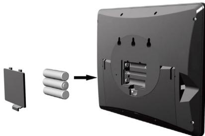
Remettez le couvercle des piles en place, dépliez le support et placez la console en position verticale.
