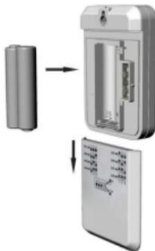
**(1) AVANT** d'installer les piles, localisez les commutateurs DIP sur le couvercle intérieur du capteur.
