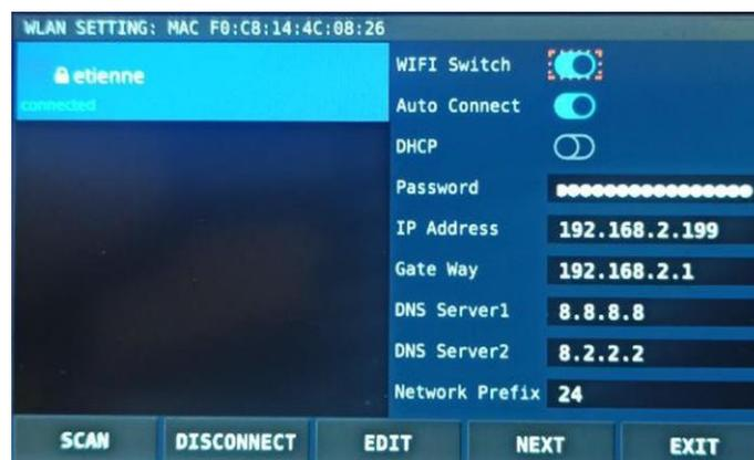
Sie können dies daran erkennen, dass nun unterhalb der WLAN-SSID in grüner Schrift „connected“ erscheint. Zudem hat sich die Beschriftung des zweiten Softkeys von „CONNECT“ auf „DISCONNECT“ geändert.
