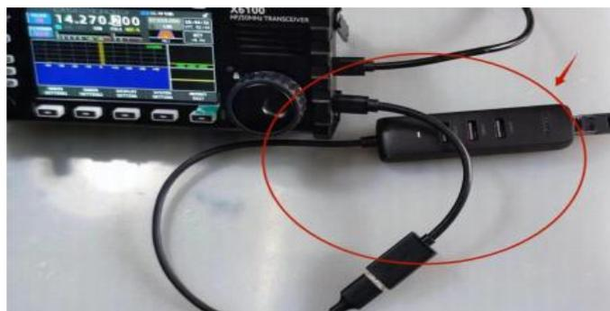
**Hinweis:** Eine kabelgebundene Netzwerkverbindung über einen am HOST-Port des Xiegu X6100 angeschlossenen LAN-Adapter hat den Vorteil, dass schwache WLAN-Signale und daraus resultierende Paketverluste vermieden werden.
