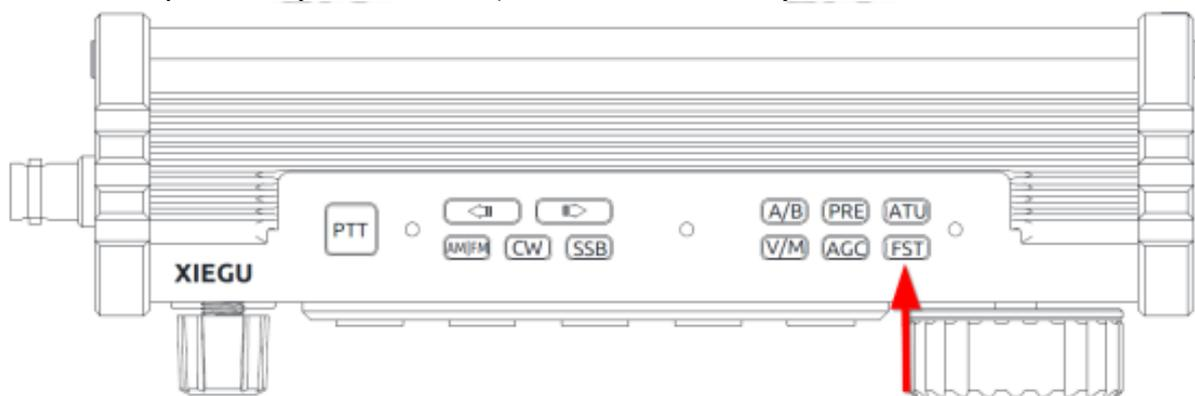
3. Utilisez ensuite le grand bouton rotatif pour modifier la fréquence de fonctionnement qui variera suivant le pas de fréquence définie.
