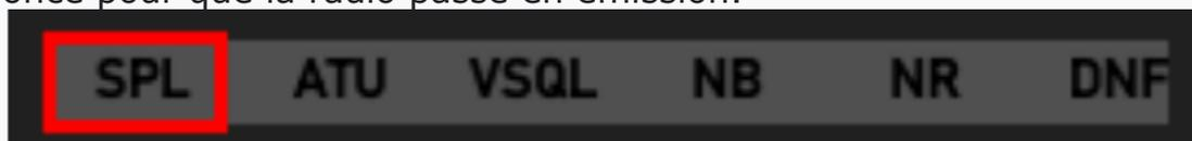
Lorsque le mode **SPLIT** est désactivé (SPL est affiché en gris dans le « Statut 1 » champ), les deux VFO peuvent être utilisés de manière totalement indépendante l'un de l'autre et ON peut basculer entre les deux VFO en **appuyant brièvement** sur le bouton **A/B** en haut Du Xiegu X6100. Le VFO opérationnel est affiché comme fréquence VFO principale.
