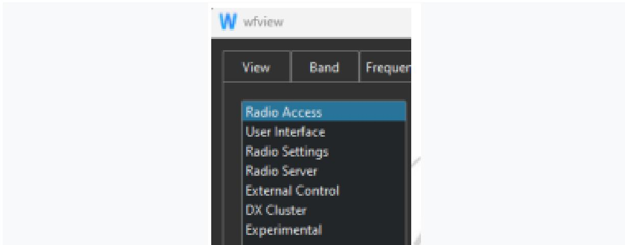
Sélectionnez « Réseau » sous « Accès radio » comme type de connexion pour coupler le X6100. Veuillez définir les paramètres des « Radios connectées au réseau » comme suit :
