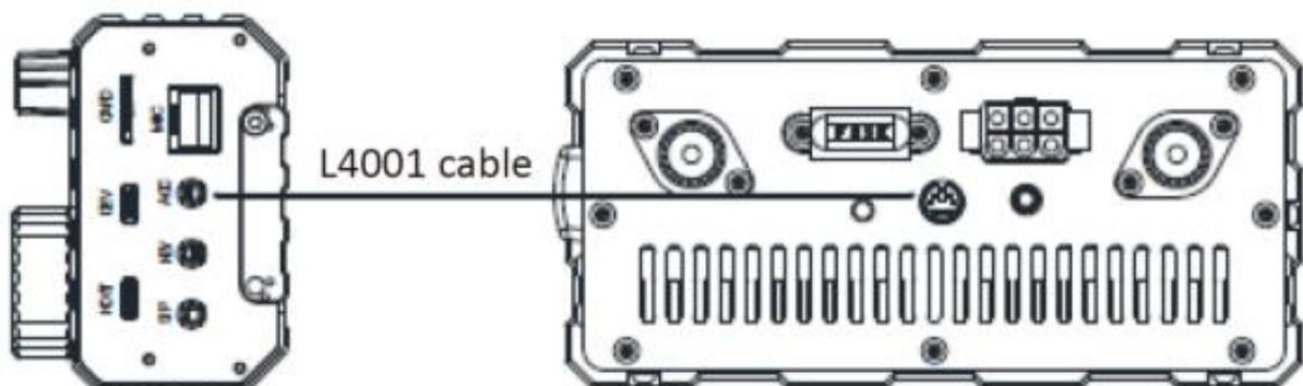
Le Xiegu X6100 change automatiquement la bande de fréquence du XPA125B, afin que l'opérateur puisse se concentrer sur les commandes du X6100. Le contrôle ALC est effectué entre les deux appareils, de sorte que si la puissance de sortie du Xiegu X6100 dépasse la limite de puissance d'entrée du Xiegu XPA125B le contrôle ALC réduit automatiquement la puissance de sortie du Xiegu X6100, pour que la puissance du Xiegu XPA125B est maintenue en toute sécurité à environ 100 W.
