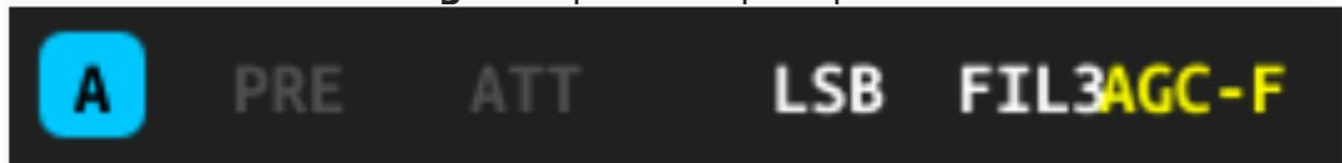
Il est recommandé de ne pas utiliser le préamplificateur dans les bandes de fréquences en-dessous de 14 MHz afin que la radio soit réglée sur l'état direct, ce qui améliore les performances frontales du récepteur et réduit l'effet des signaux interférents. Si le niveau indique qu'un signal reçu dépasse 40 dBm, il est recommandé d'allumer l'atténuateur pour éviter que le récepteur ne soit surchargé par un niveau de signal d'entrée excessif.
