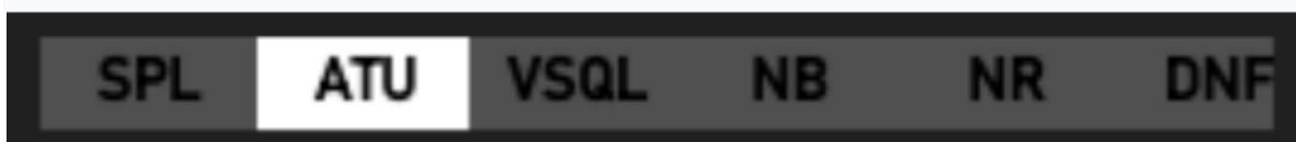
2. Appuyez et **maintenez enfoncé** le bouton **[ATU]** sur le dessus du boîtier pour lancer l'**adaptation de l'antenne** connectée à la fréquence de fonctionnement actuellement réglée.
