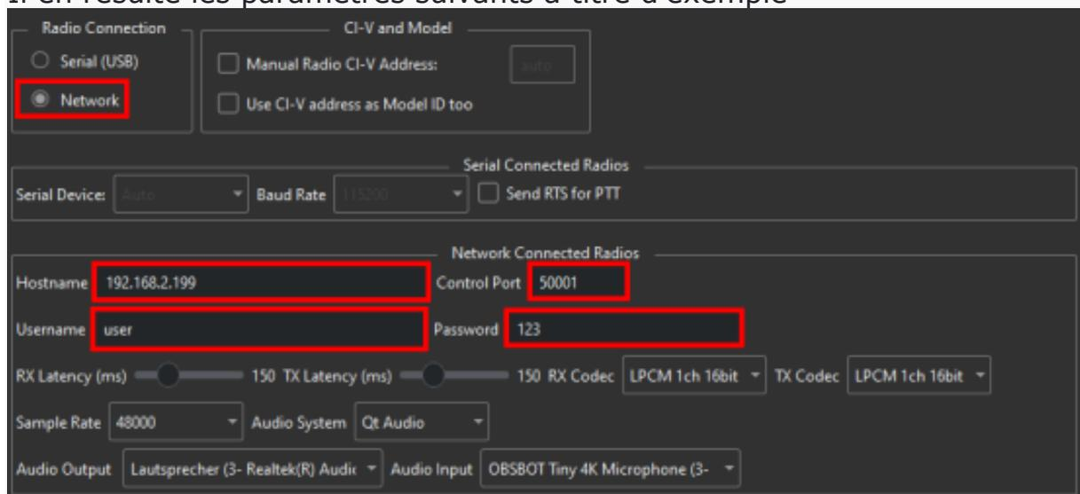
Vous devez ensuite vérifier les paramètres de sortie audio et d'entrée pour wfview exécuté sur l'ordinateur. Ceux-ci se trouvent sous les rubriques « Sortie audio » et « Entrée Audio' sous les paramètres de communication précédemment ajustés.
