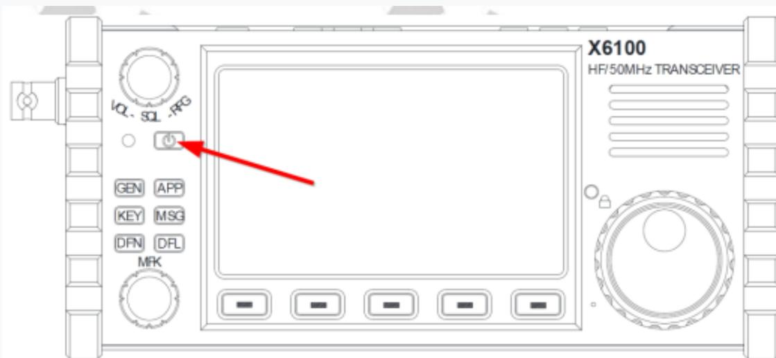
2. Appuyez ensuite successivement sur les boutons suivants : [GEN] → SYSTEM SETTING pour accéder au menu des paramètres du système
