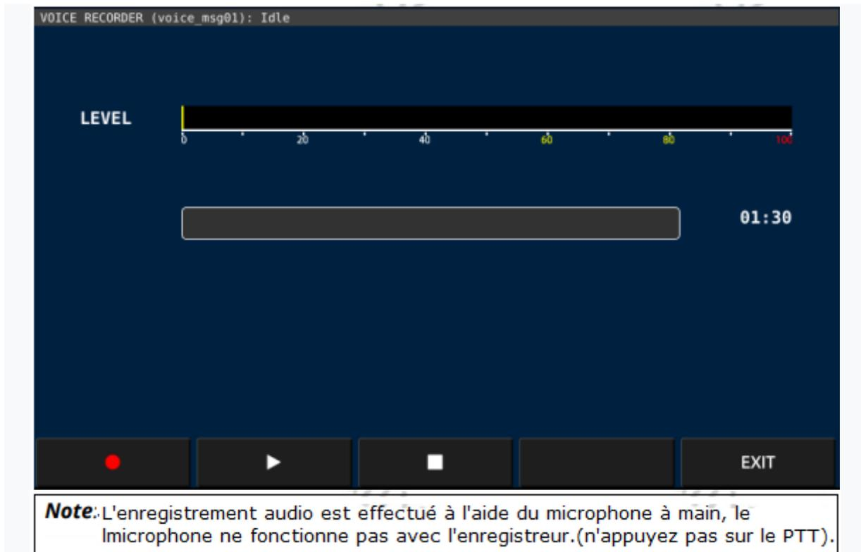
L'enregistreur vocal peut maintenant être utilisé à l'aide des touches logicielles :
