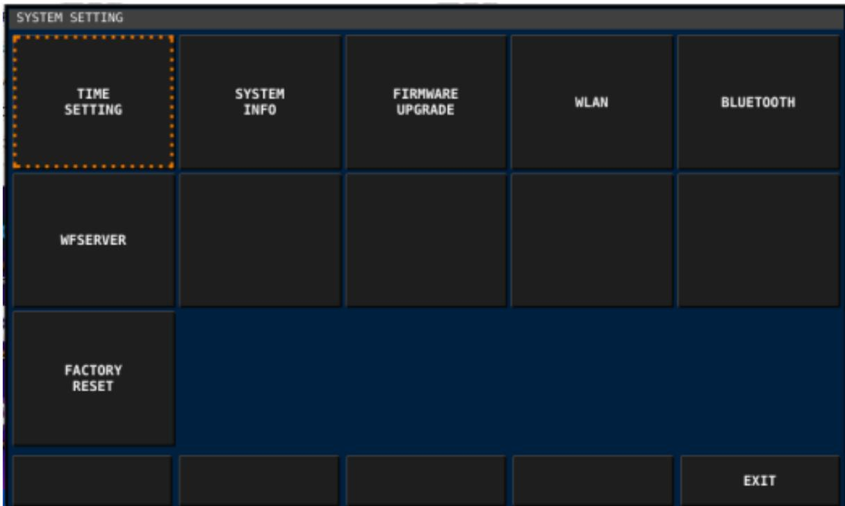
3. Sélectionnez maintenant « FIRMWARE UPGRADE » à l'aide du bouton rotatif MFK (en bas à gauche, à côté) sur l'écran LCD) et confirmez votre sélection en appuyant brièvement sur le bouton rotatif MFK
