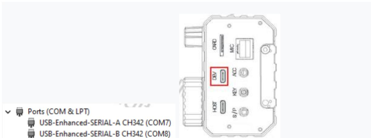
Le port virtuel étiqueté **SERIAL-B** est utilisé pour les modes de fonctionnement numériques tels que **FT8** via **WSJT-X** et pour le contrôle **CAT**.
