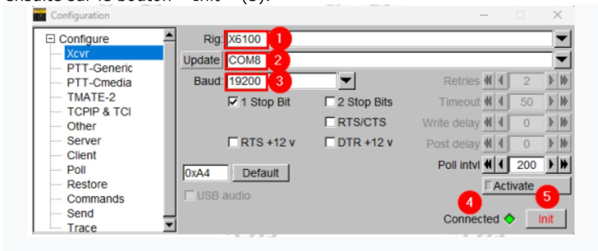
Vous entendrez du bruit des solénoïdes à l'intérieur du Xiegu X6100. Après la séquence d'initialisation est terminée, l'étiquette « Init » du bouton (5) ne doit plus être imprimé en rouge, mais en noir et l'indicateur LED (4) doit être coloré en vert.
