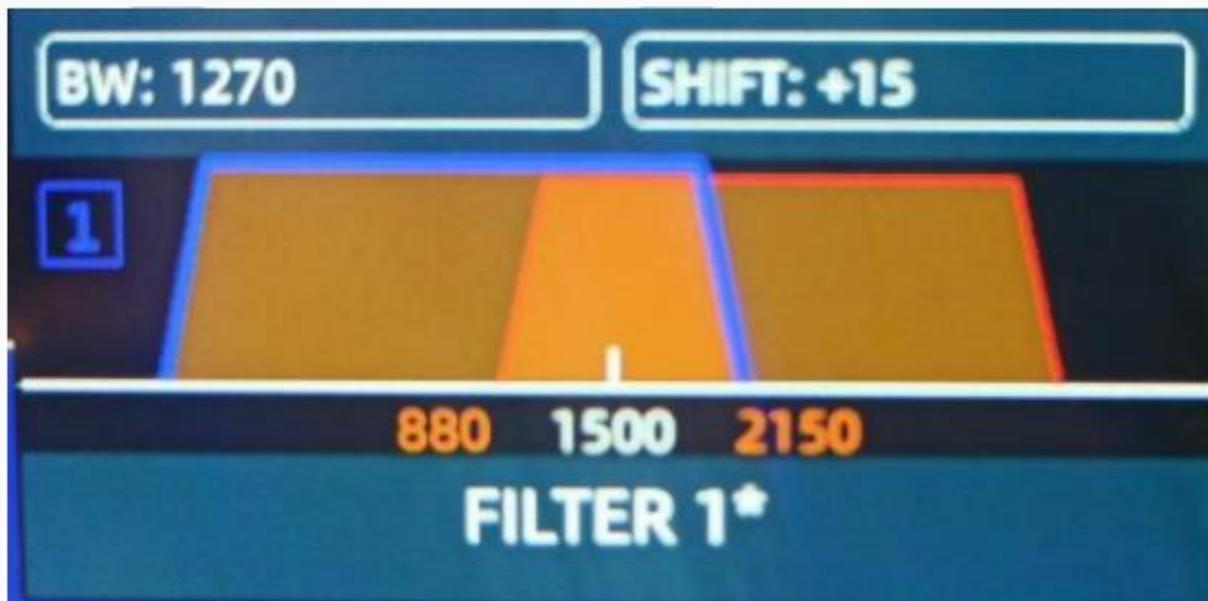
Commutation entre le filtre passe-bas affiché en bleu et le filtre passe-haut indiqué en rouge se fait en appuyant sur le bouton rotatif MFK
