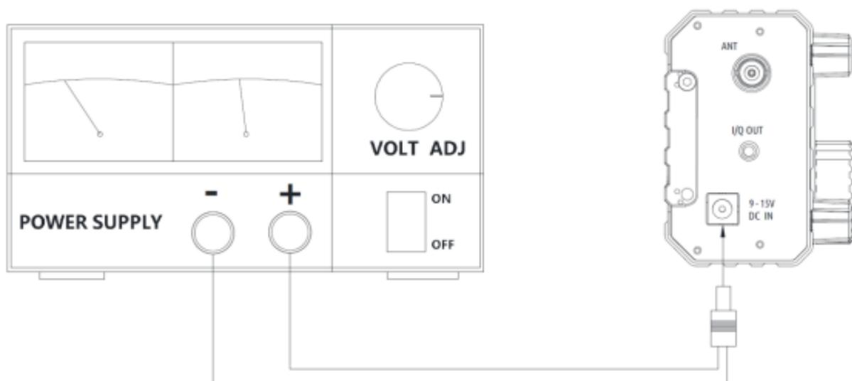
Pour empêcher les interférences externes de pénétrer dans la radio via les lignes électriques et pour empêcher que les interférences de radiofréquence dans la radio ne soient rayonnées vers l'extérieur via les lignes électriques lorsque le Xiegu X6100 fonctionne avec une Alimentation électrique, des anneaux de ferrite EMC Clip-on supplémentaires peuvent être fixés au DC câble d'alimentation. Si possible, les anneaux de ferrite doivent être fixés à proximité de la radio.
