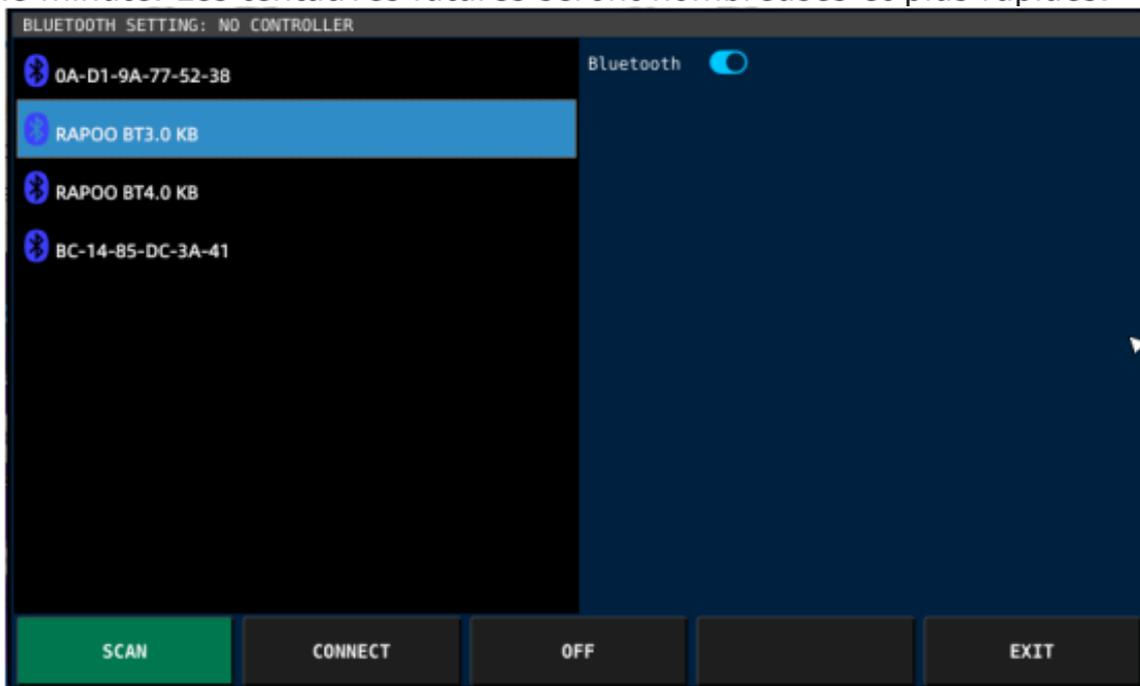
Utilisez maintenant le bouton rotatif MFK pour sélectionner un appareil parmi les appareils répertoriés sur le côté gauche, puis confirmez votre sélection en appuyant sur la touche logicielle « CONNECT ».
