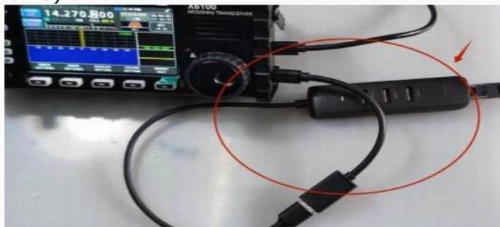
**Note:** Une connexion réseau filaire via un adaptateur LAN connecté au port HOST du Xiegu X6100 a l'avantage que les signaux Wi-Fi faibles et le résultat la perte de paquets est évitée
