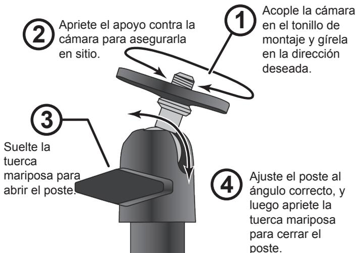
2. Apriete el apoyo de la cámara hacia arriba contra la cámara AppCam 23 para asegurarlo en sitio.
