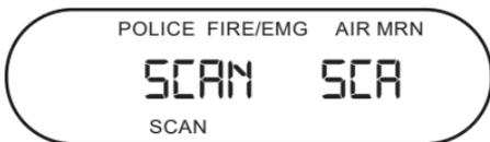
Cet écran indique que le scanneur BC355N balaye activement une banque affichée. **SCAN** défilera de droite à gauche de l'écran, et la banque sélectionnée clignotera.
