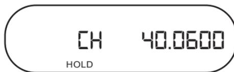
À un mode de balayage normal (une banque de canaux clignote). Appuyez sur **PROG.** **HOLD** apparaîtra **CH** apparaîtra et clignotera. Maintenez enfoncé **L/O** pendant 2,5 secondes.
