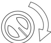
2. Tournez la commande **SQ** dans le sens horaire jusqu'à ce que le bruit disparaisse. Ceci est le seuil auquel le signal entrant est légèrement plus puissant que le bruit de fond, ce qui ouvrira la suppression du bruit de fond.
