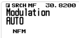
*NOTA: Cuando está ajustado a AUTO, la modulación por defecto se selecciona automáticamente para cada frecuencia.*
