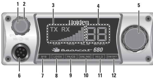
1. Rueda del **control del volumen (Volume)** con **Power On/Off**. (encendido/apagado de la alimentación).
