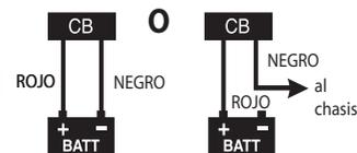
Conecte el cable rojo de alimentación CC del transceptor al borne positivo (+) de la batería u otro punto conveniente. Luego conecte el cable negro de alimentación al chasis del vehículo o al borne negativo (-) de la batería.
