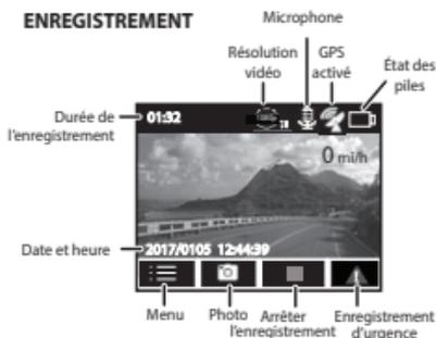
Les icônes au bas de l'écran se trouve au dessus des touches au bas de l'écran du dispositif. Pour activer une de ces quatre icônes de l'écran, appuyez sur le bouton correspondant sous l'icône.
