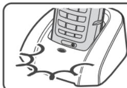
Assurez-vous que le voyant à DEL **charge** s'allume lorsque le combiné repose sur le chargeur.
