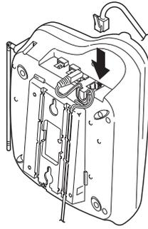
4. Coloque el cable telefónico dentro del canal moldeado en la parte de abajo de la base. Después, conecte el otro extremo del cable telefónico en el enchufe modular de la pared.
