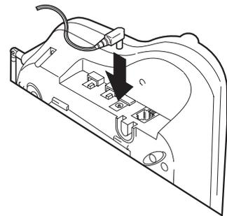
3. Coloque el cable del adaptador CA dentro del canal moldeado.
