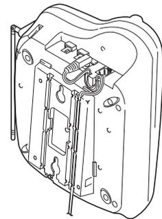
4. Conecte un extremo del cable largo telefónico en el enchufe TEL LINE de la base.
