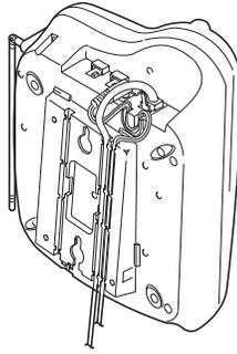
6. Coloque la base sobre los tornillos y empuje hacia abajo hasta que esté colocada firmemente.
