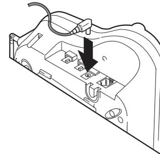
2. Coloque el cable del adaptador CA dentro del canal moldeado.
