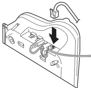
5. Conecte el otro extremo del cable en el enchufe telefónico de la pared.
