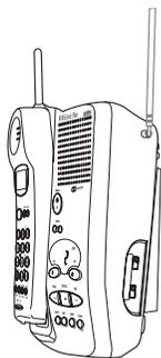
2. Asegúrese de que el símbolo de la batería se encienda. Si el símbolo no se enciende, inspeccione si el adaptador CA está enchufado, y que el receptor esté haciendo buen contacto con los contactos para cargar de la base.
