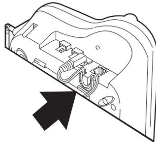
4. Conecte un extremo del cable largo telefónico en el enchufe TEL LINE en la base.
