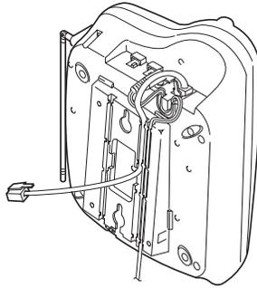
5. Coloque la base sobre los postes de la placa de la pared y empuje hacia abajo hasta que esté firmemente colocada.
