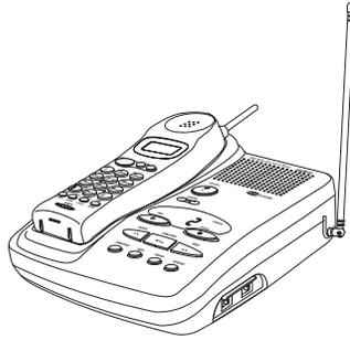
2. Conecte el cable del adaptador CA en el enchufe de entrada CC de 9V en la base.
