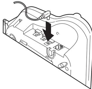
3. Coloque el cable del adaptador CA alrededor de la aleta para relevar la tensión.
