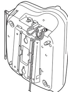
3. Conecte un extremo del cable corto telefónico en el enchufe TEL LINE de la base.
