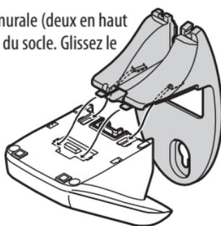
Passez le cordon de l'adaptateur CA dans la petite encoche au bas du support de fixation et laissez le cordon pendre sous le support de fixation.
