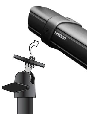
1. Fixez le support de fixation à la vis de montage sur chaque caméra. Vous pouvez fixer le support sur le dessus ou sur le dessous de la caméra.
