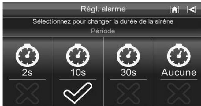
2. Tapez la durée désirée pour la sirène (2, 10 ou 30 secondes) ou Aucune pour mettre la sirène hors fonction.
