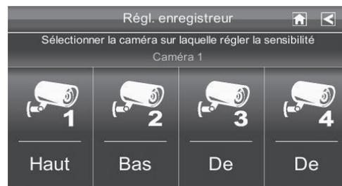
1. La sensibilité de la détection du mouvement peut être réglée indépendamment. Vous pouvez régler le niveau de sensibilité à *H/F, Faible* ou *Élevée*. Tapez sur la caméra pour permuter entre les options.
