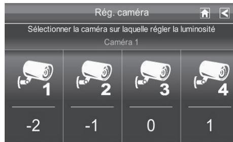
Tapez l'icône de la caméra pour laquelle vous désirez régler la luminosité. Le niveau de luminosité par défaut est 0, et vous pouvez la régler de -2 à 2.
