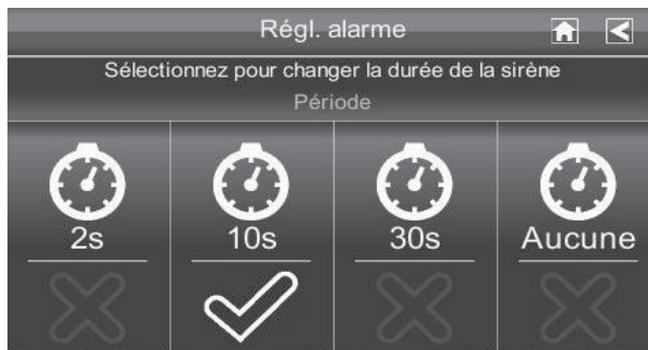
2. Tapez la durée désirée pour la sirène (2, 10 ou 30 secondes) ou Aucune pour mettre la sirène hors fonction.
