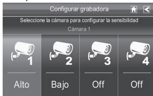
1. La sensibilidad de la detección de movimiento de cada cámara se puede configurar independientemente. Usted puede poner el nivel de la detección de movimiento a apagado, bajo, o a alto. Toque en la cámara para circular por esas opciones.
