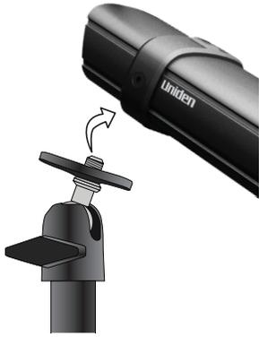
1. Para cada cámara, acople el soporte de la cámara en el tornillo de montaje. Usted lo puede acoplar en la parte superior o inferior de la cámara según lo necesite. Enrózquelo un poco, y luego gire la cámara a la dirección deseada.
