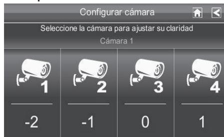
Toque la cámara en la cual desea cambiar el nivel de la claridad. La claridad predeterminada es 0, y el rango es de -2 hasta 2.
