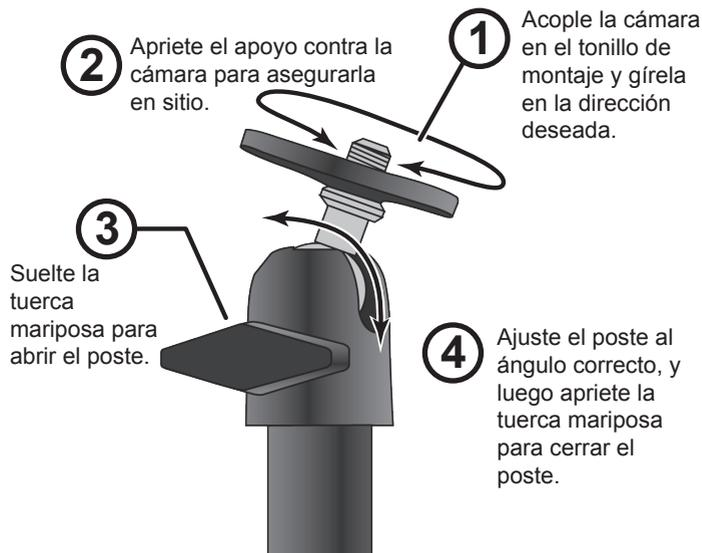
2. Apriete el apoyo de la cámara hacia arriba contra la cámara para asegurarlo en sitio.
