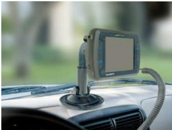
1. Déterminez le meilleur emplacement pour le disque de montage en surface. Fixez le dispositif au bras de support. Positionnez la ventouse à plat sur la surface et ajustez la position de manière à vous permettre de voir l'écran d'affichage sans obstruer votre champ de vision.
