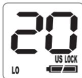
La fonction de verrouillage du clavier demeure activée lorsque vous mettez la radio hors fonction et en fonction à nouveau. Pour déverrouiller le clavier, maintenez de nouveau la touche **LOCK** enfoncée. **LOCK** disparaîtra.
