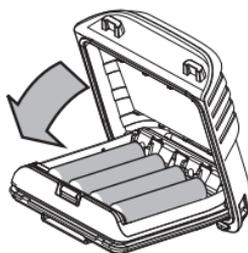
**AVERTISSEMENT! Le compartiment est conçu pour éviter la recharge accidentelle des piles alcalines. N'utilisez jamais les piles de la radio sans le compartiment des piles. Ne tentez pas de modifier le design du compartiment des piles.**
