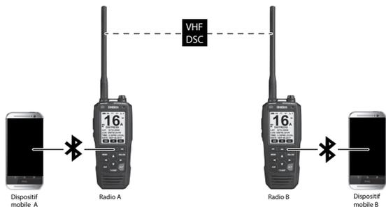
Saisissez du texte sur le dispositif mobile A. Le dispositif mobile A transmettra à la radio A par l'entremise de Bluetooth. La radio A transmettra à la radio B par l'entremise du VHF DSC. La radio B transmettra au dispositif mobile B par l'entremise de Bluetooth.
