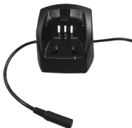
Connexion au traceur de cartes via un câble de sortie NMEA0183.
