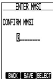
Si opta por no insertar su número MMSI específico al empezar, usted todavía puede usar muchas de las características de su radio; sin embargo, usted no podrá usar las características DSC. Vaya a **MENU/DSC SETUP/RADIO MMSI NUMBER** para insertar el número MMSI después de la activación inicial.
