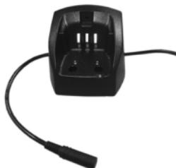
Conectar al trazador de mapas vía el cable de salida NMEA0183.
