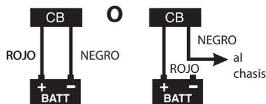
Conecte el cable rojo de alimentación CC del transceptor al terminal positivo (+) de la batería o a otro punto conveniente. Luego, conecte el cable negro de alimentación al chasis del vehículo o al terminal negativo (-) de la batería.
