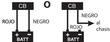
Luego, conecte el cable negro de la alimentación al chasis del vehículo o al terminal negativo (-) de la batería.
