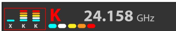
Le réglage du menu Priorité détermine quel type de fréquence s'affiche sur l'écran OLED (voir la page 20). Si la priorité est réglée sur *Signal priority*, le signal le plus fort s'affiche sur l'écran OLED. Si la priorité est réglée sur *Priorité Ka*, le signal radar de la bande Ka s'affiche sur l'écran OLED.
