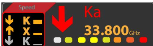
Le menu *Priority* permet de déterminer quel type de fréquences apparaîtront à l'affichage OLED. Si *Priority* est réglé à *Signal*, le signal le plus puissant apparaîtra à l'affichage OLED. Si *Priority* est réglé à *Ka Priority*, le signal de la bande radar Ka sera affiché à l'affichage OLED.
