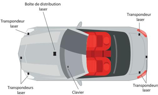
Connectez la boîte de distribution laser au port RJ11 du R4w ou du R8w. Connectez le clavier au port RJ11 de l'adaptateur d'alimentation.
