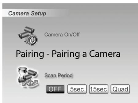
1. Utilisez les touches ◀ / ▶ pour changer les intervalles de balayage "Scan Time" entre OFF/5 sec/15 sec/Quad.
