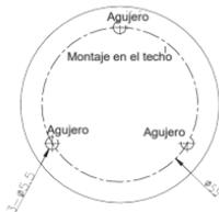
3. Pase los cables y fije la base de montaje en el techo con tres tornillos (incluidos).
