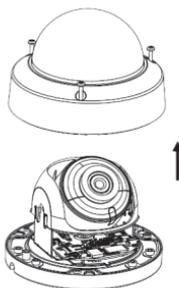
***Los tornillos no se desenroscan completamente para no perderlos.***
