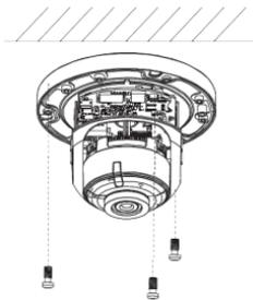
4. Ajuste el ángulo de visión. Afloje un tornillo para ajustar la inclinación y ajuste cuando sea necesario. Apriete el tornillo.
