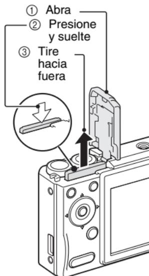
**Mantenga presionada la tarjeta con el dedo hasta que quede completamente insertada o salga expulsada.**
