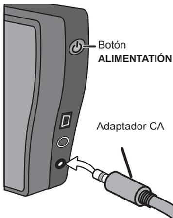
2. Conecte una antena detrás de cada cámara y conecte un adaptador CA en el latiguillo de entrada de la cámara. (Si es necesario, conecte el cable de extensión en el latiguillo de la cámara y conecte el adaptador CA a un cable de extensión)
