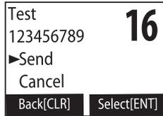
5. La radio cambia automáticamente al canal 70 para transmitir la llamada de prueba, y luego vuelve a cambiar al último canal usado.
