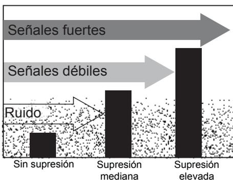
Mientras que escucha un canal, ajuste la rueda **SQUELCH** hasta que filtre el ruido y sólo oiga la transmisión. Si cambia a un canal con mucho ruido o con una transmisión débil, tendrá que ajustar el nivel de la supresión otra vez.
