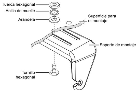
6. Vuelva a instalar la radio en el soporte.
