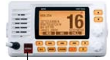
Soulevez le couvercle et appuyez sur le bouton DISTRESS en dessous
